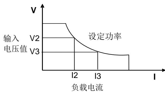
图 3-4 CW 模式电压电流图
