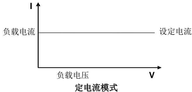
图 3-1 CC 模式电压电流关系图
