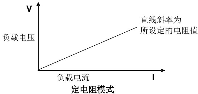
图 3-3 CR 模式电压电流关系图
