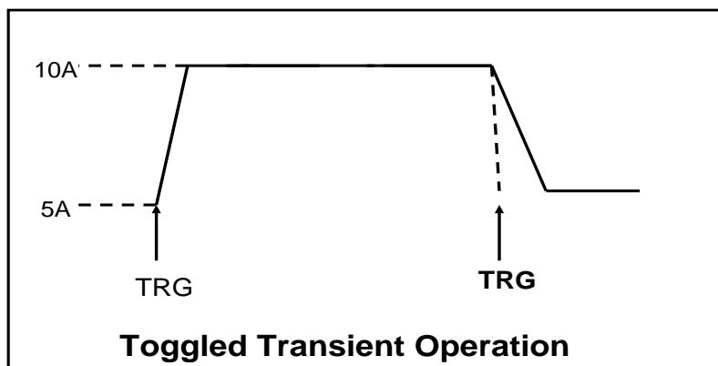
以 CC 模式为例 (其他模式操作类似), 当被测仪器输出电压为 10V, 电流 3A, 负载电流在 1A 和 2A 之间切换, 设置动态测试参数和执行动态测试步骤如下:
