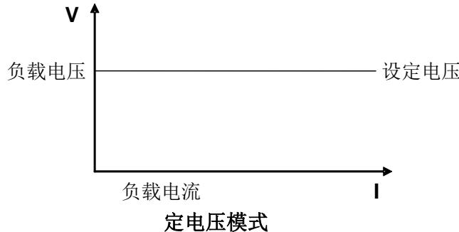
图 3-2 CV 模式电压电流图
